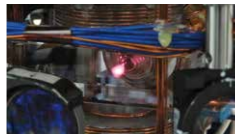
図 2 レーザー冷却された Rb 原子集団
