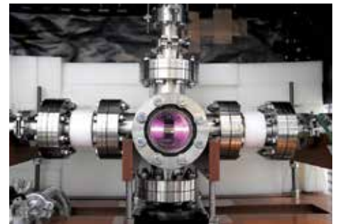
図 1 リング電極を用いた D-D 核融合型小型中性子源
