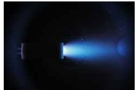
図 3 電磁加速型電気推進ロケット
