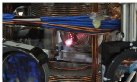
図 2 レーザー冷却された Rb 原子集団
